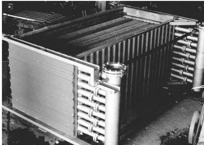
Рис. 2. Экономайзер из плоскоовальных труб с неполным оребрением
