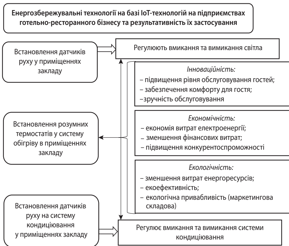
Рис. 6. Енергозберезувальні технології на базі IoT-технологій на підприємствах готельно-ресторанного бізнесу та результативність їх застосування
